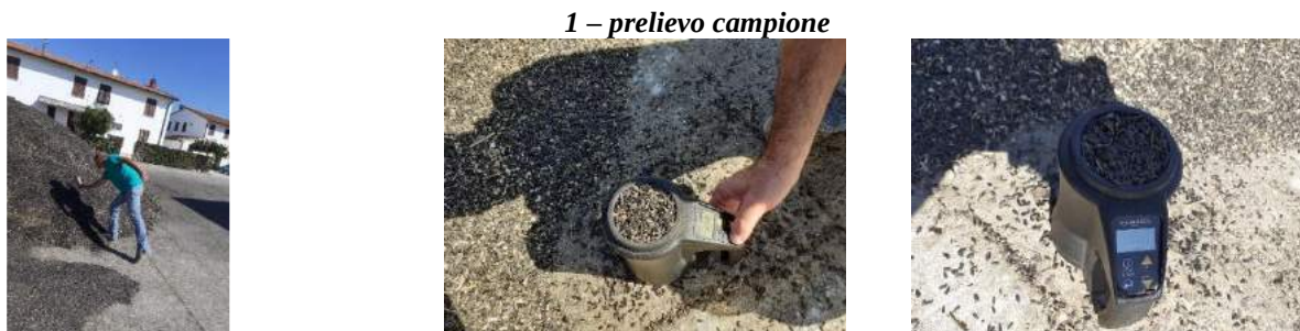
Figura 15 – Fasi del campionamento e analisi rapida del girasole al centro di stoccaggio di Cascina
